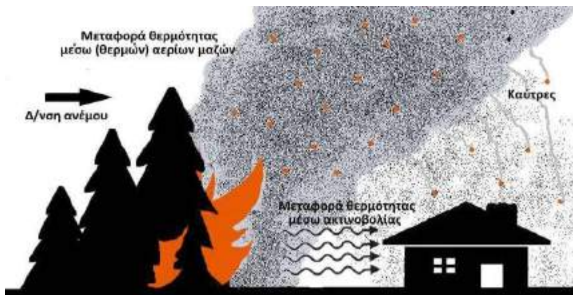
Σχέδιο 3. Τρόποι ροής της θερμότητας σε μια δασική πυρκαγιά, που εξελίσσεται πλησίον κτιρίου και απεικόνιση πιθανού τρόπου μετάδοσης δασικής πυρκαγιάς με μεταφερόμενες καύτρες σε
